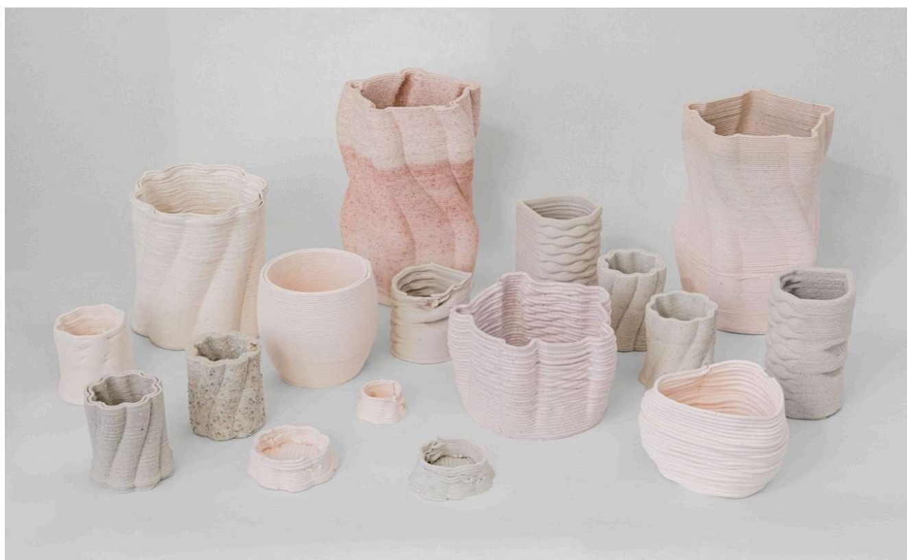
Figura 2 – Conjunto de peças, após sinterização, impressas a partir de pasta de porcelana com carga de vidro em diferentes percentagens.
